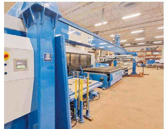
Pohjanmaan hissitekniikan hallitilasta löytyi muun muassa tämä Finn Power -tasolaserkone manipulaattorilla. Kuva Harri Pinola
