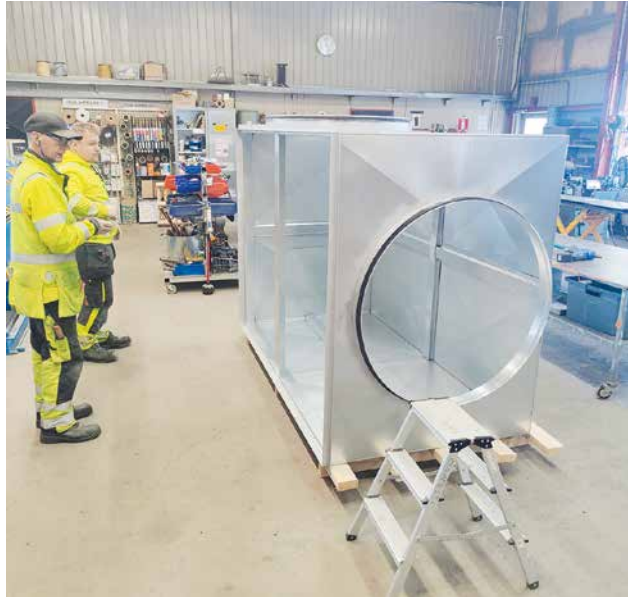
Oulapellin valmistama poistoilmakammio toimitetaan Oulaisiin nousevalle Ledenin hallille. Kammion vieressä Jouko Pirnes ja Aate Vähäsöyrinki.
