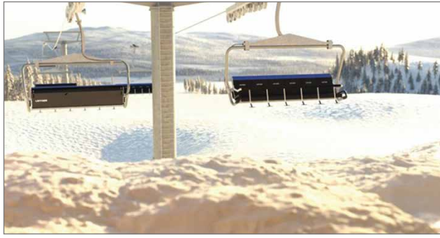
Hissiyhtiö Leitnerin 6-paikkainen tuolihissi kuljettaa jatkossa sekä laskettelijat, pyöräilijät, että kävelijät Iso-Syötteen huipulle alle kolmessa minuutissa.
