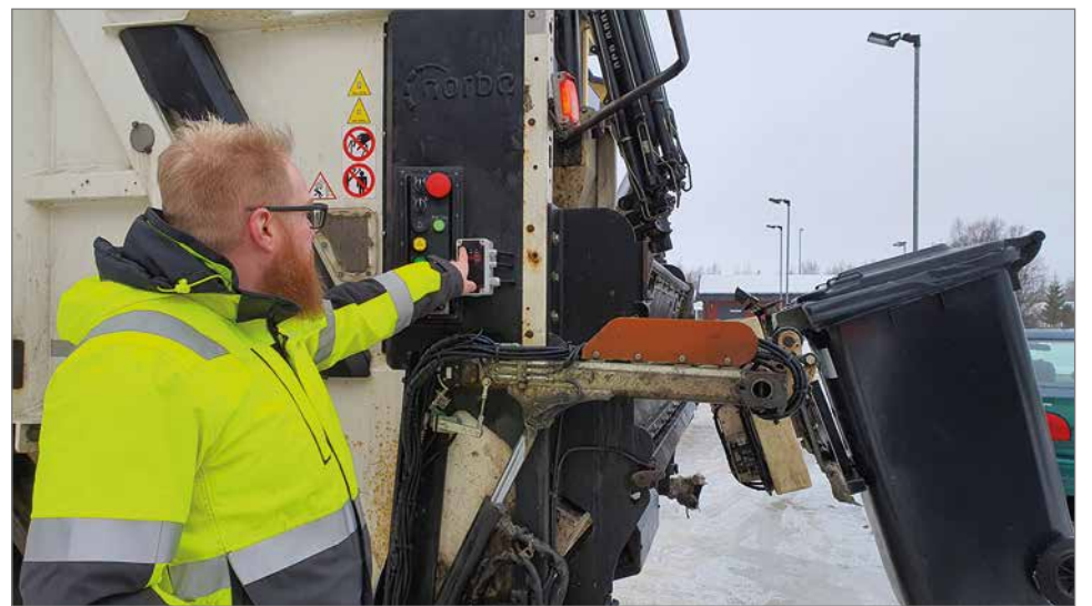
Punnitusjärjestelmän vihreä valo palaa, kun sensori on tunnistanut astian, näyttää Kiertokaaren logistiikkapäällikkö Veli-Pekka Pyörälä.
