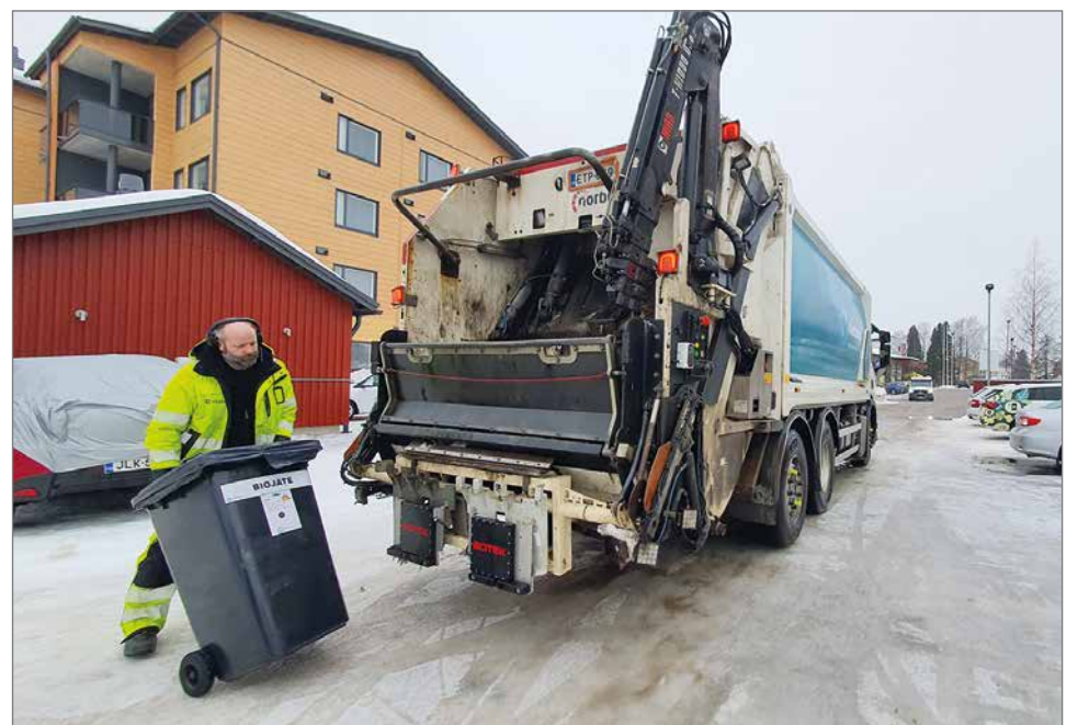
Jäteautoon on asennettu kaksi vaaka, jotka näkyvät hyvin auton takaosassa punaisella BO-TEK-tekstillä merkittynä. Jussi Jouppi tyhjentää biojäteastiaa.
