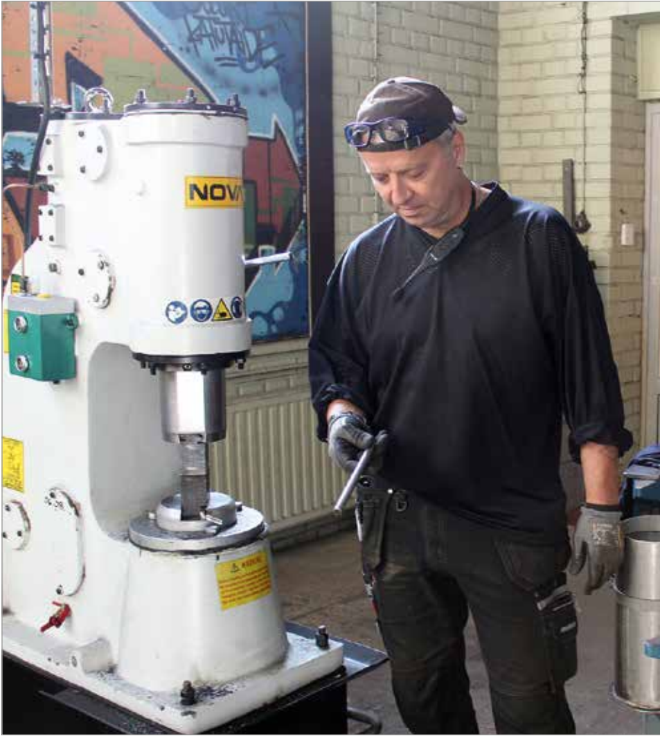
Ari Malmberg kertoo kaiken alkavan hopeateräsaihiosta, josta hän työstää terät vieressä olevalla pneumaattisella konevaralla.
