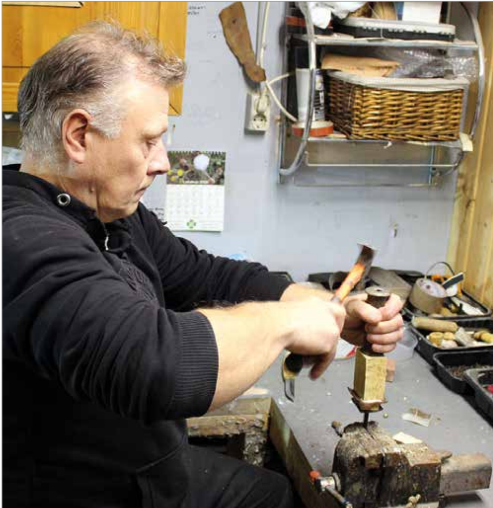
Puukonteko on mitä suurimmassa määrin perinteistä käsityötä. Arto Keltamäki aloittamassa kahvan liittämistä terään, jonka jälkeen alkaa kahvan työstäminen.
