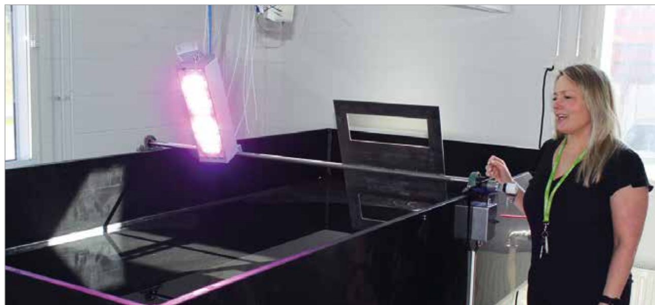
Projektipäällikkö Johanna Laukkanen esittelee testilaitteistoa, jossa kasvatetaan levää puhdistuen ja talteen ottaen vedestä ravinteita raaka-aineeksi.
