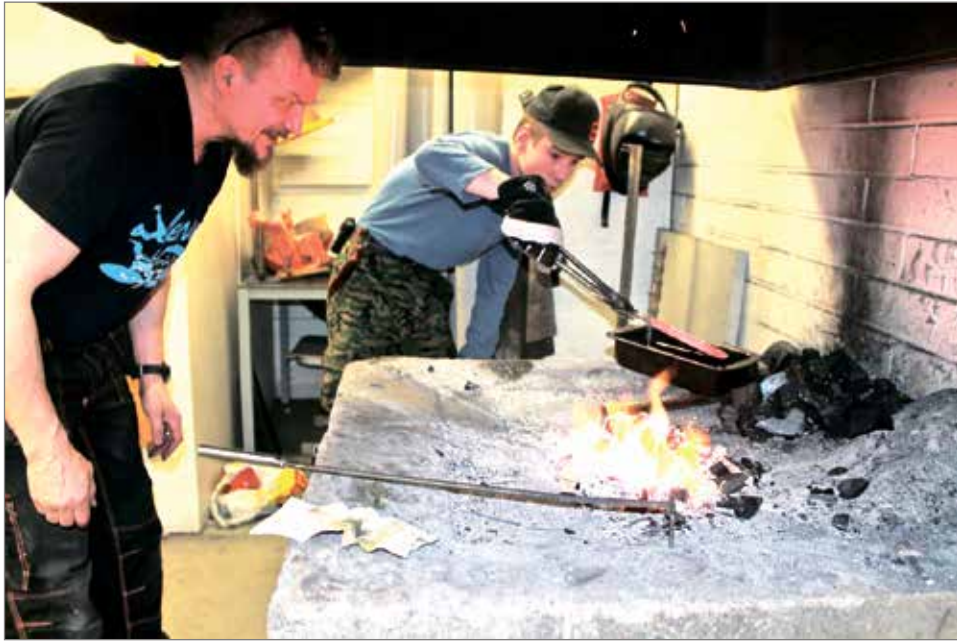
Kohta suhahtaa. Ismo Kauppinen (vas.) tarkkailee, kun Jussi-Pekka Paaso on viemässä hehkuvaa terää öljyyn.
