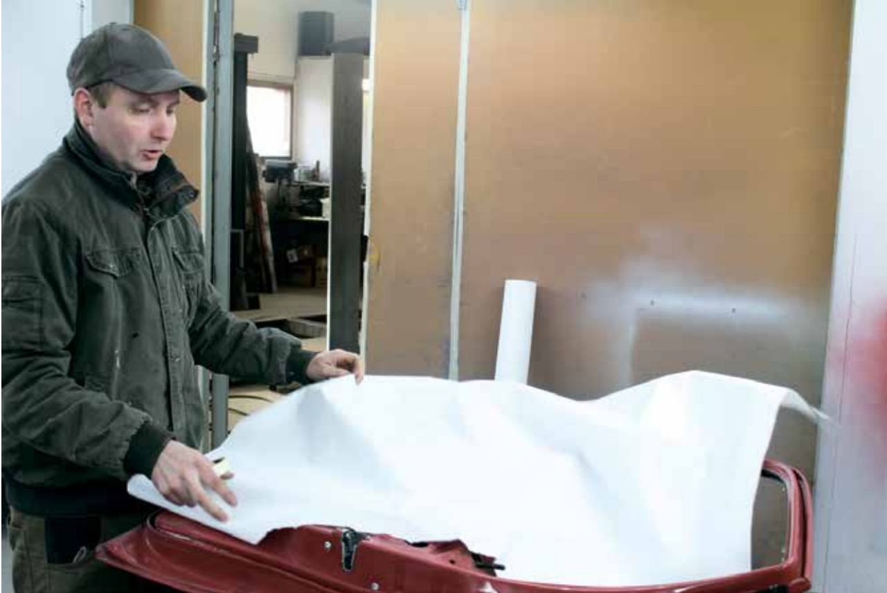
Kimmo Tiiri suojaustyössä valmistellessaan Mersun ovea maalauksille. Punaisesta ovesta maalataan hopea Mersuun sopiva ovi.
