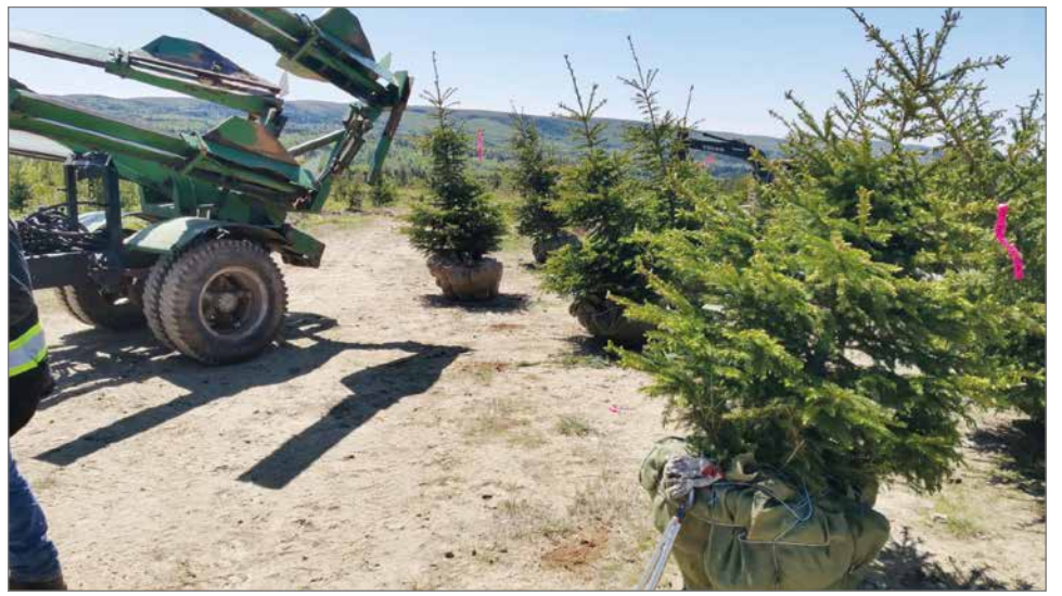
Eräänlainen konelapio, jota käytetään isojen taimien nostosta. Nämä taimet menivät J.D Irving Nature Parkiin.
