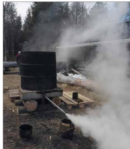
Tervanpolttoon käytettiin 200-litraista tervanpolttopönttöä ja valettua tervauslavaa.
