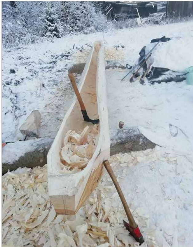
Rungon koverttamistyöhön käytettiin telsoa eli kourukirvestä ja veistokirvestä.
