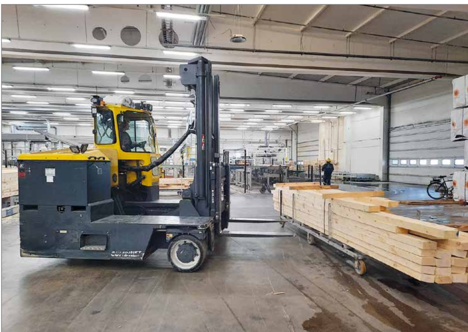
Combiliftin sähkökäyttöinen trukki on ympäristöystävällinen ja hiljainen työväline, jolla voi siirtää jopa kahdeksan tonnin kuormia.
