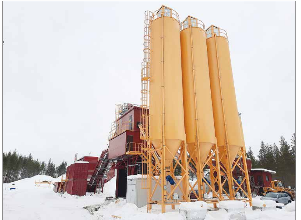
Yhden sideainessiilon vetoisuus on 120 tonnia.
