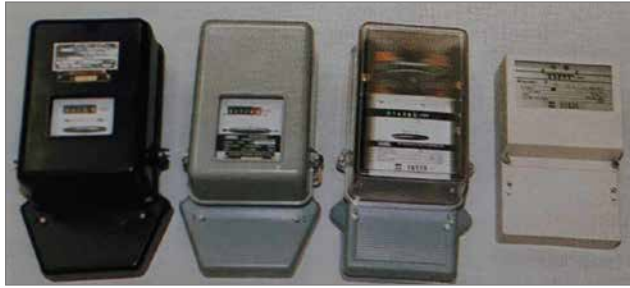
Kuva Koillis-Pohjan Sähkön asiakaslehdessä, jossa kotitalouksien kilowattitunti-mittareita 50-luvulta 90-luvulle. Tänä päivänä etäluettavat mittarit ovat joka taloudessa. Kuva: Reijo Talala.
