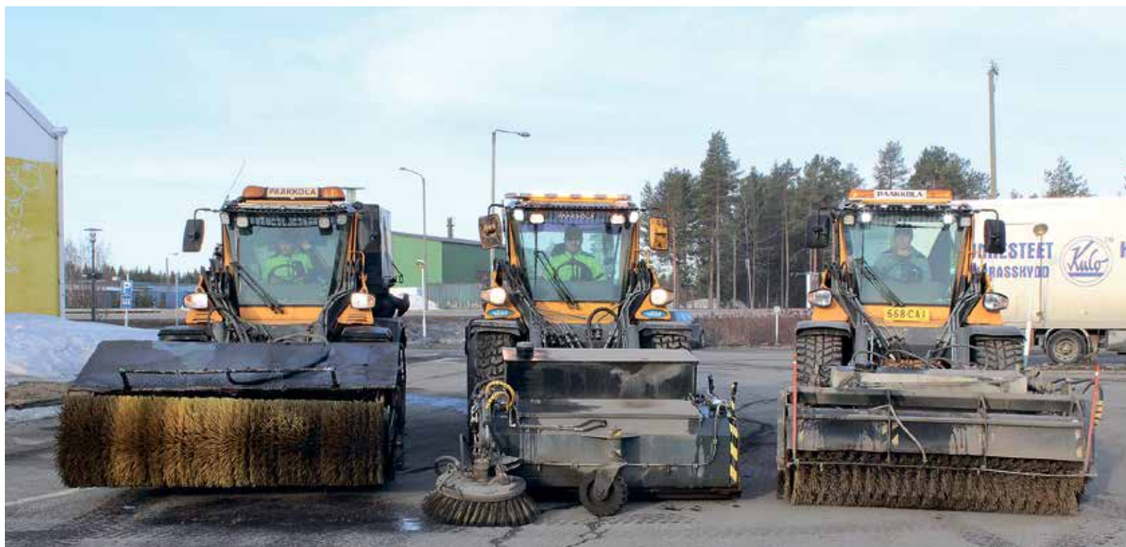
Hiekanpoistot pihoilta hoituvat joutuisasti kolmella Wille-kiinteistöhoitokoneella. Ohjaimissa Mikko Paakkola, Veli Paakkola ja Mikko Mähönen.
